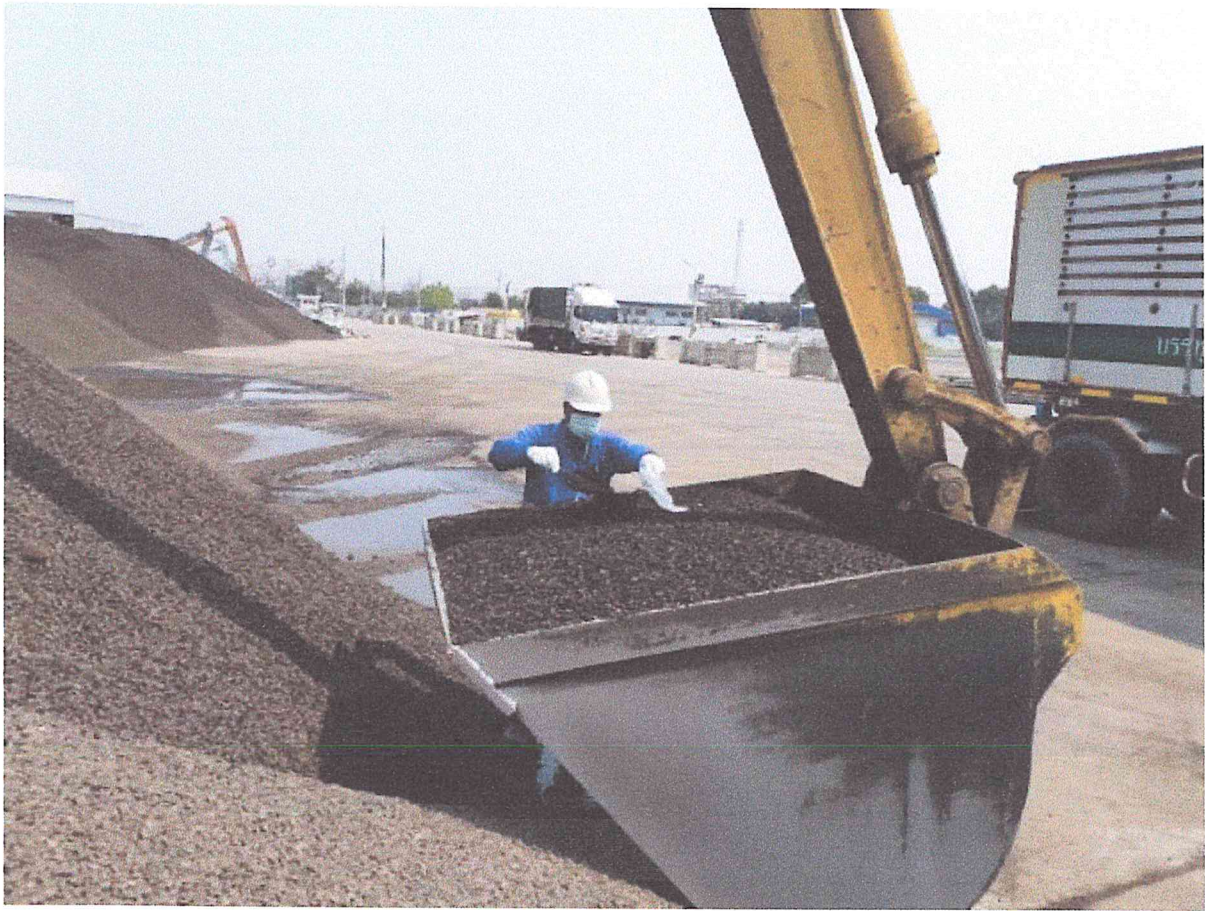
พนักงานQC เก็บตัวอย่างก่อนโหลดสินค้า ส่งห้องปฏิบัติการเพื่อตรวจสอบความชื้นให้เป็นไปตามสเปคที่ลูกค้าต้องการ
