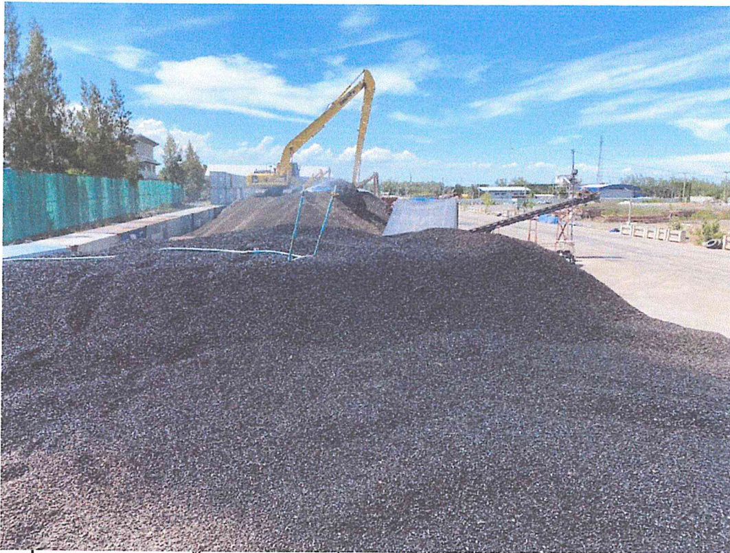
ภาพที่ 8 มีการสเปรย์น้ำตลอดเวลาเพื่อทำให้เกิดความชื้นบนกองกะลาปาล์มและ ทำให้ไม่เกิดฝุ่นละออง
